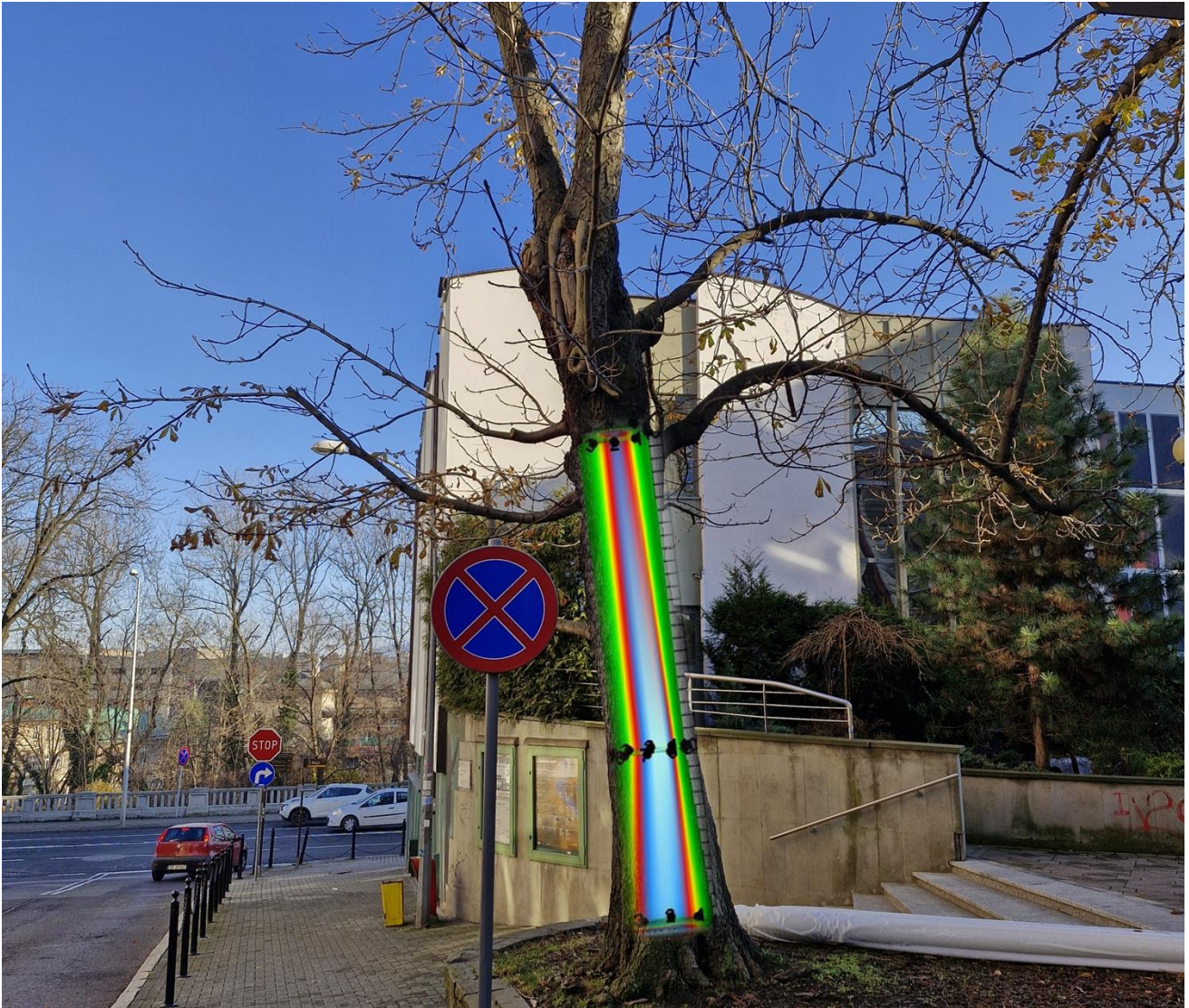
Pień kasztanowca od strony W. Nałożony tomogram ukazuje przebieg ubytku kominowego.
